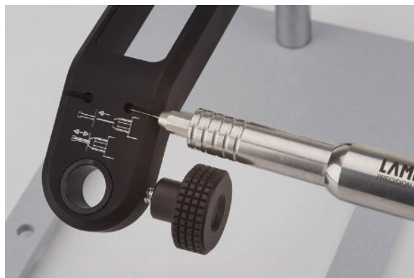
Fig. 5.2 Regolazione della lunghezza dell'elettrodo con braccio di tenuta dell'utensile
